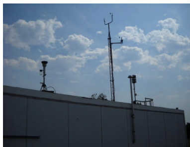
Figure 3: Station d'analyse de l'air en continu. (Paris-Charles de Gaulle Nord)
